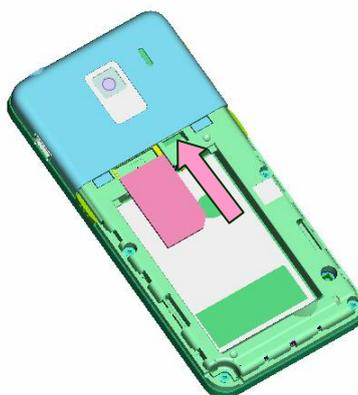
5. 将电池重新装入电池舱中，确保电池的金属触点和手机的金属触点相接触并且电池完全卡入电池舱中。
